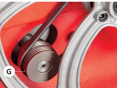
Ensemble guide-lame supérieur pour scie à ruban SRP10 DUAL Poulie d'entraînement à deux vitesses (G)
